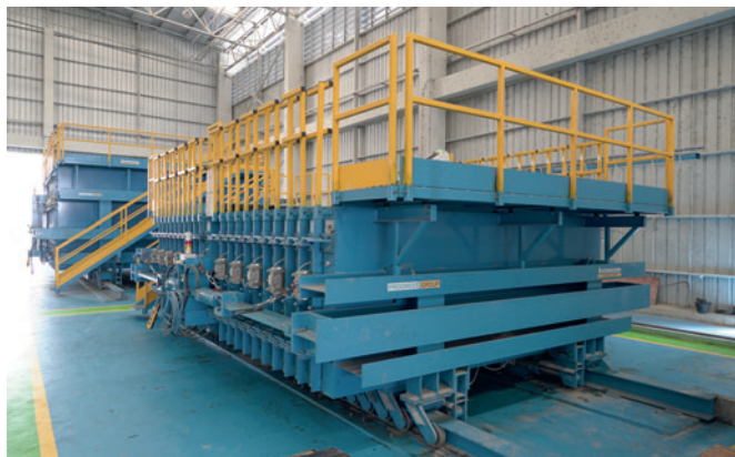
Z wykorzystaniem nowych form bateryjnych firma Sansiri produkuje ściany działowe i elementy ogrodzeń.
