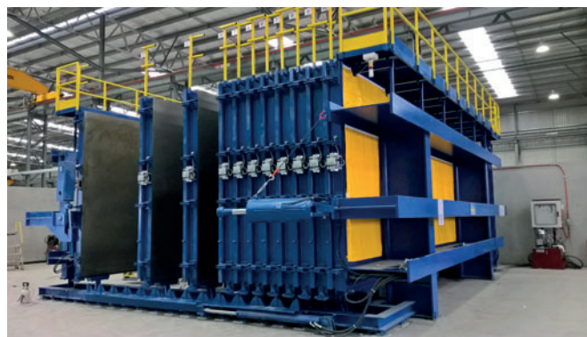
A fôrma tipo bateria da Tecnom foi recentemente instalada na BGC, a primeira empresa que usa essa tecnologia na Austrália Ocidental.
