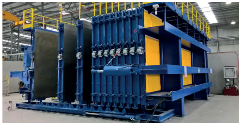
La batterie de coffrage de Tecnocom a été récemment installée chez BGC, la première entreprise à utiliser cette technologie en Australie-Occidentale.
