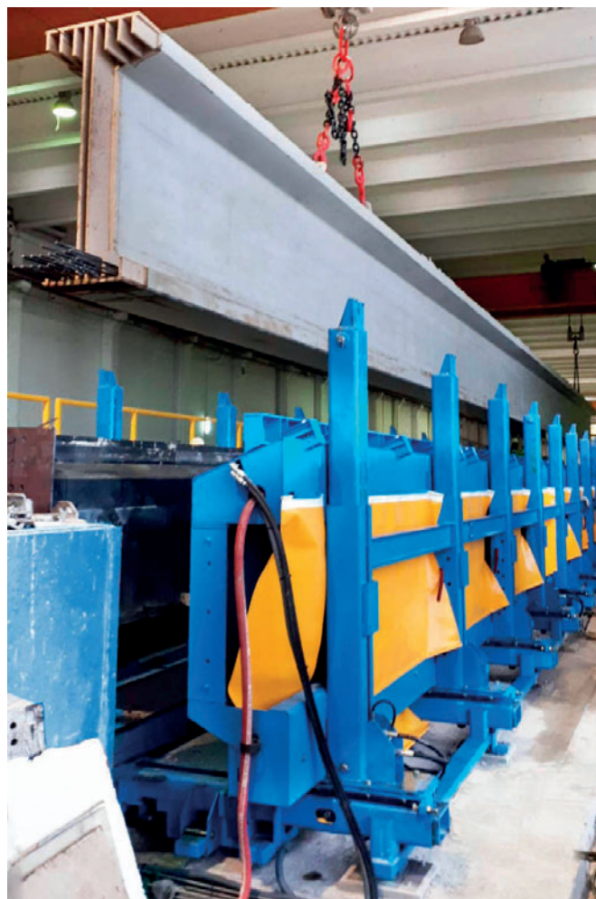
Entnahme des betonierten Trägers aus der variablen Schalung mit individuell anpassbaren Abschnitten.
