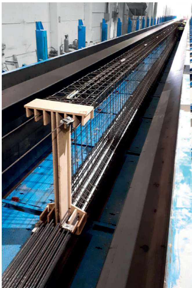
Die sehr flexible und automatische Schalung zur Herstellung von Trägern wurde speziell für Hormipresa konstruiert.
